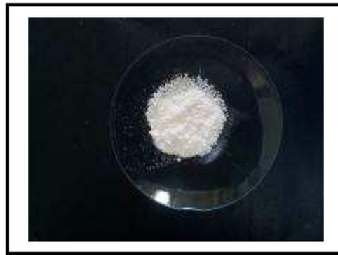
**Gambar 4.** Hasil pengeringan nanopartikel dengan menggunakan *freeze dryer*
